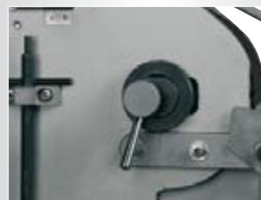
■ Nastavení pásu pomocí rychloupínací páky – není potřeba žádná nářadí
