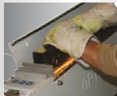
■ Opěrka umožňuje stabilní zapření broušeného materiálu
